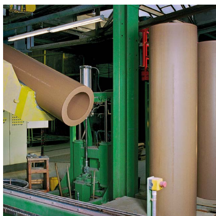
Vormgeving van de buizen
